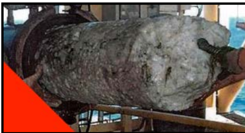
Σχήμα 1.5: Μεγάλος υδριτης μεθανίου που δημιουργήθηκε μέσα σε υποθαλάσσιο αγωγό υδρογονανθράκων. ( http://www.pet.hw.ac.uk/research/hydrate/hydrates_why.cfm )
