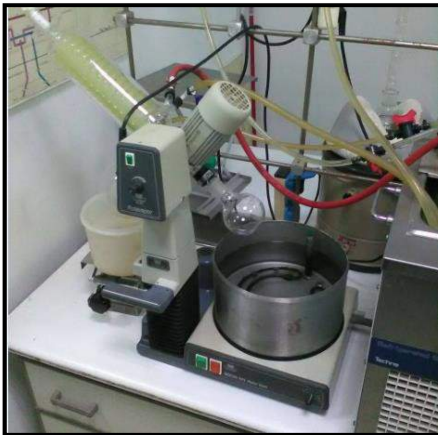
Σχήμα 4.5: Περιστροφικός εξατμιστήρας (rotary evaporator) (Εργαστήριο Ανάλυσης Ρευστών και Πυρήνων Υπόγειων Ταμιευτήρων)
