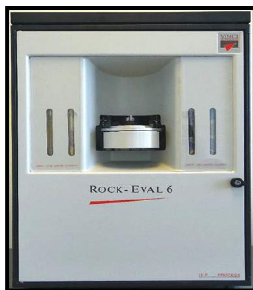
Σχήμα 4.2 Αναλυτικό όργανο Rock-Eval 6 (Εργαστήριο Ανάλυσης Πυρήνων και Ρευστών Υπόγειων Ταμιευτήρων).
