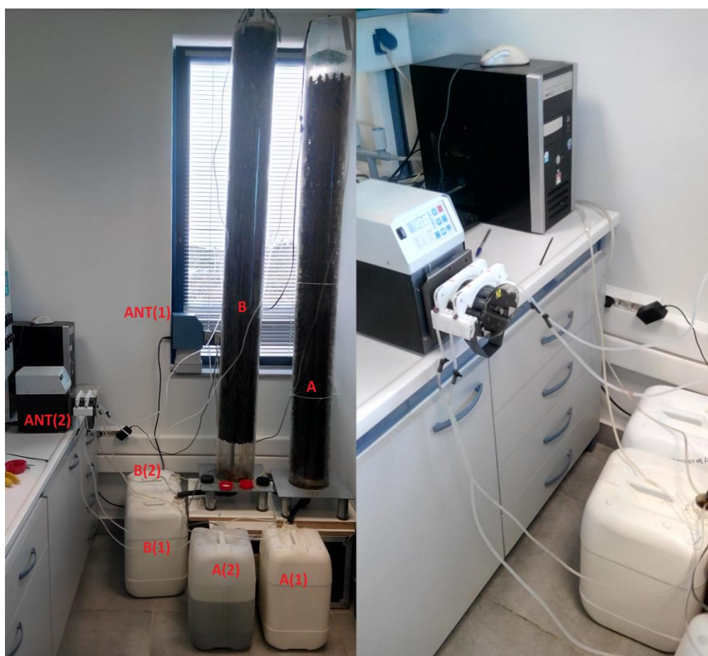
Εικόνα 6.2.1. : (αριστερά) :διάταξη κυκλοφορίας και ανακυκλοφορίας , (δεξιά): αντλία ανακυκλοφορίας
