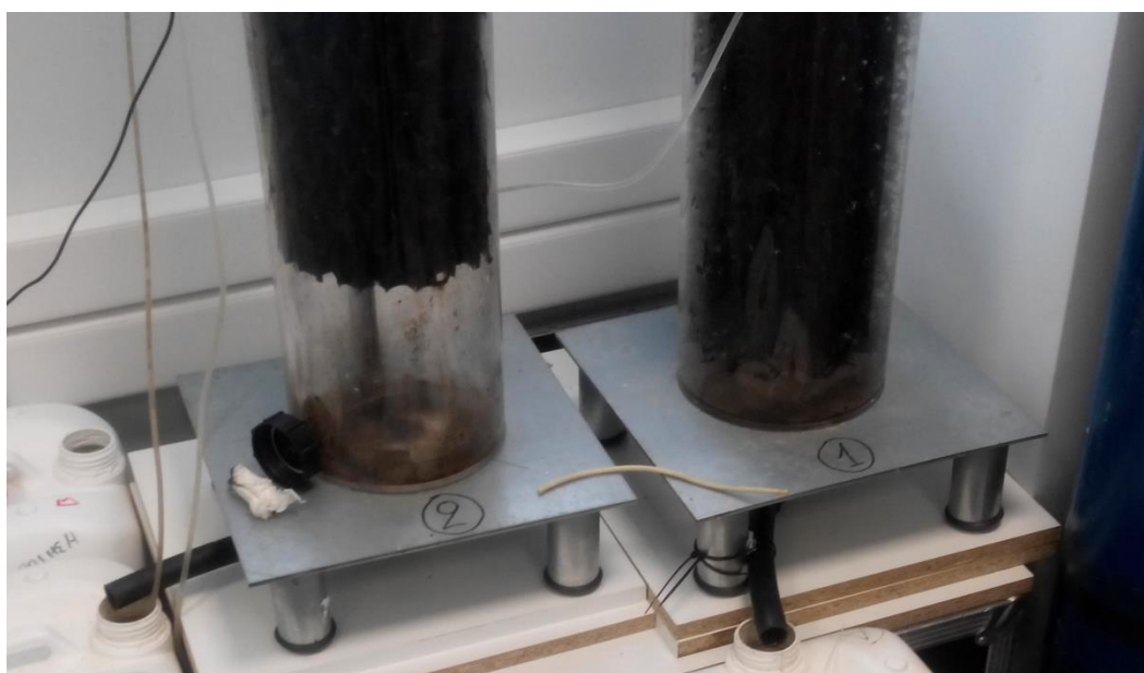
Εικόνα 5.2.2. : βάσεις στήριξης και σωληνώσεις εξόδου επεξεργασμένου αποβλήτου
