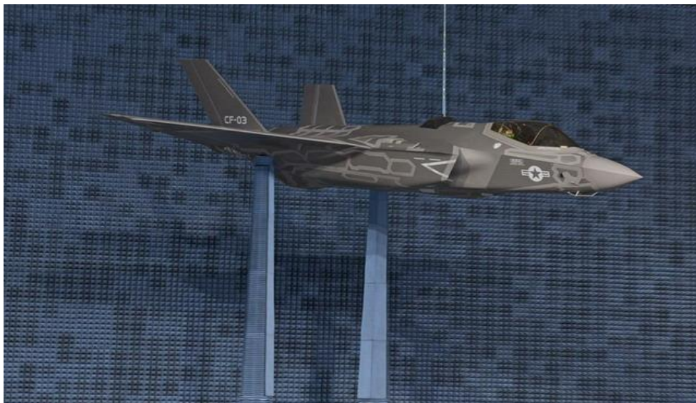
Εικόνα 3.1 Α/Φ F-35 της Lockheed Martin υποβάλλεται σε μέτρηση υπολογισμού τιμών RCS [41]
