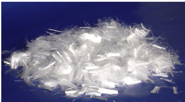
Σχήμα 3.2: Ίνες πολυπροπυλενίου μήκους 6-8mm.
