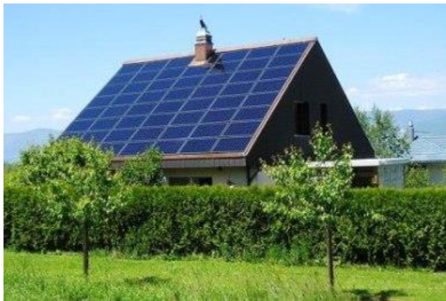
Σχήμα 1.2 Παράδειγμα φωτοβολταϊκού συστήματος ενσωματωμένου στην οροφή κτιρίου.
