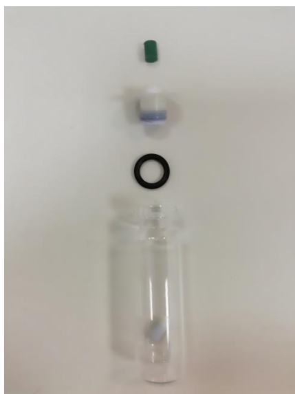
Εικόνα 11. Πειραματική διάταξη για Vac-HSSPME
