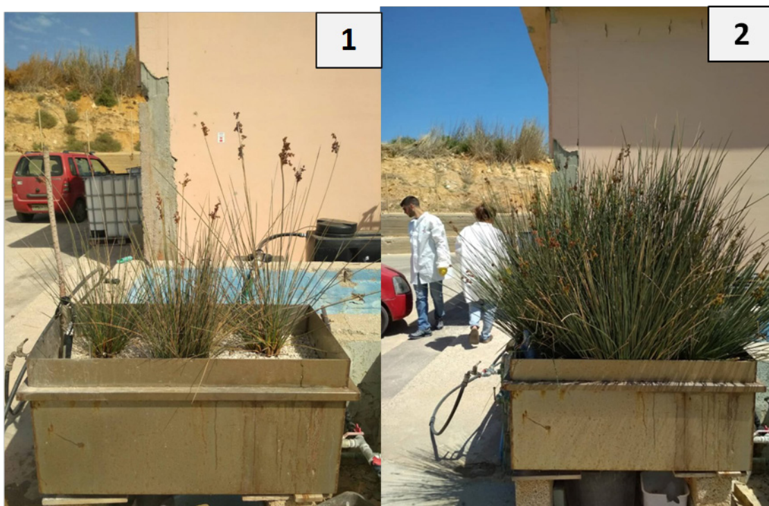
Εικόνα 3.6: (1) Ο τεχνητός υγροβιότοπος την ημέρα της φύτευσης (Αύγουστος 2017), (2) Ο τεχνητός υδροβιότοπος στο τέλος του πειράματος (Μάιος 2018).
