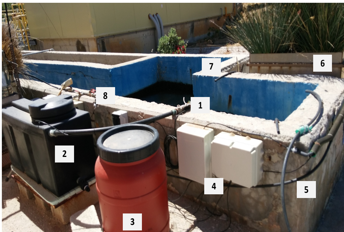
Εικόνα 3.2: Φωτογραφία της πειραματικής εγκατάστασης: (1) σωλήνας της υποβρύχιας αντλίας που τροφοδοτεί με λύμα την δεξαμενή εξισορρόπησης από το κανάλι εκροής δευτεροβάθμιας επεξεργασίας, (2) δεξαμενή εξισορρόπησης, (3) δεξαμενή βαρέων μετάλλων, (4) Κουτιά που περιέχουν τις αντλίες, (5) σωληνάκια που μεταφέρουν το λύμα και το διάλυμα βαρέων μετάλλων στον τεχνητό υγροβιότοπο, (6) τεχνητός υγροβιότοπος, (7) έξοδος τεχνητού υγροβιότοπου στο κανάλι εκροής δευτεροβάθμιας επεξεργασίας (8) ασφαλειοκιβώτιο
