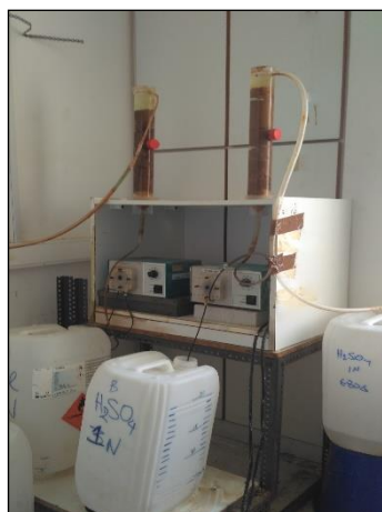
Εικόνα 3.4: Σύστημα εκχύλισης σε στήλες
