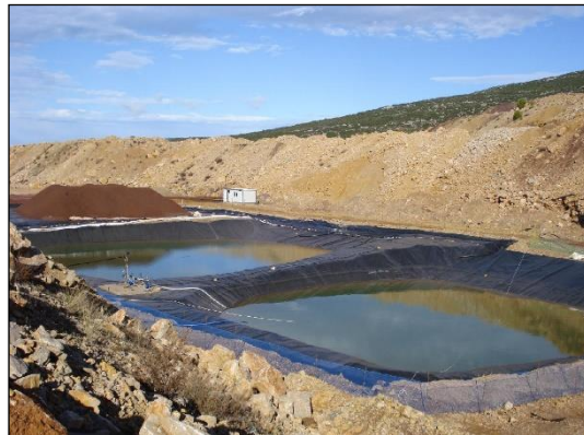
Εικόνα 2.7: Σωρός εκχύλισης και δεξαμενές συλλογής εκχυλισμένου διαλύματος ( http://www.hydrometallurgy.metal.ntua.gr/Drippers%20Installation.htm )
