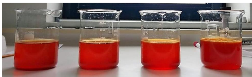
Εικόνα 3.3: Κροκιδωμένα δείγματα μετά την προσθήκη 500, 1000 και 2000 ppm FeCl_3
