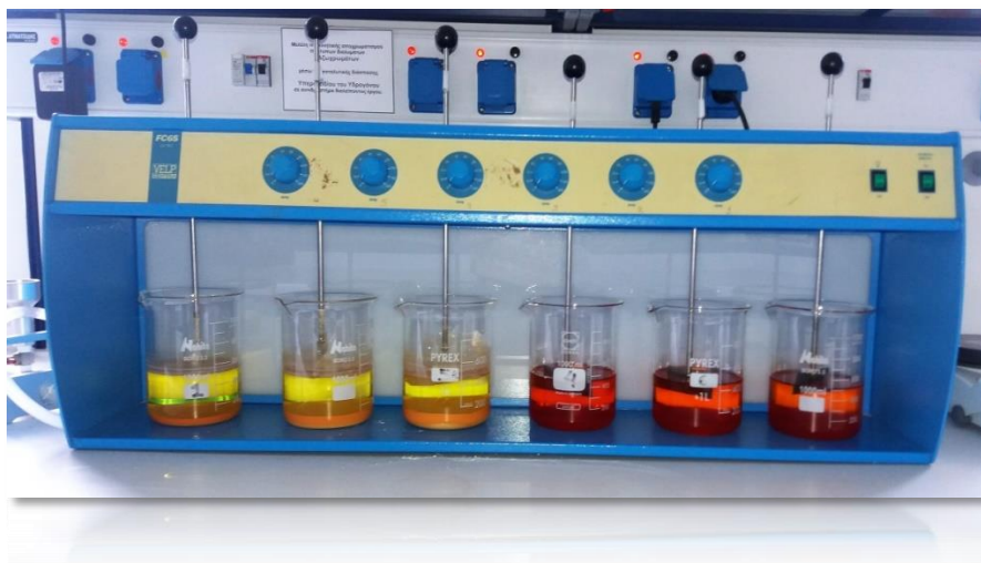
Εικόνα 2.3: Εργαστηριακή διάταξη μηχανικής ανάμιξης πειράματος jar-test
