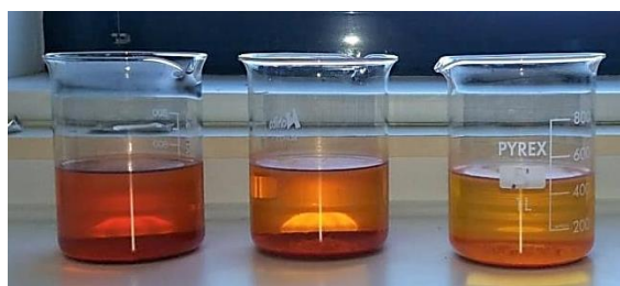
Εικόνα 3.2: Κροκιδωμένα δείγματα μετά την προσθήκη 5000, 10000 και 15000 ppm CaO
