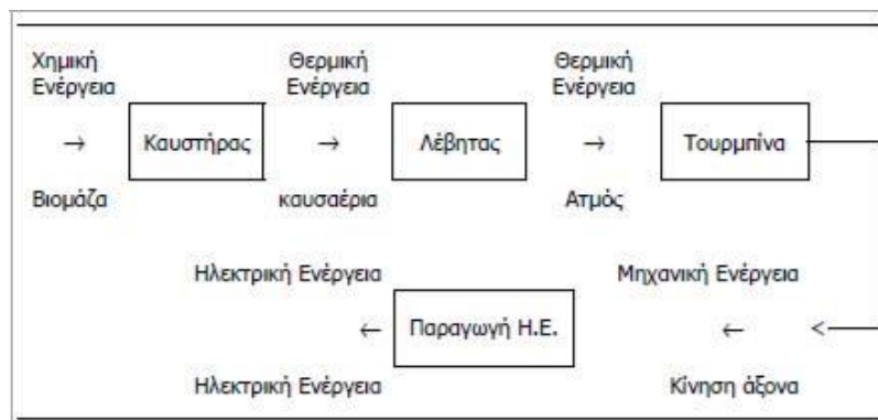
Σχήμα 4.18: Διάγραμμα ροής της παραγωγής ηλεκτρικής ενέργειας από βιομάζα
