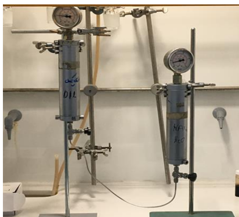
Εικόνα 27 Συνδεσμολογία incubator chamber υπό πίεση, εντός εργαστηρίου
