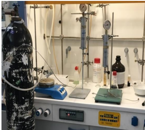
Εικόνα 26 Συνδεσμολογία incubator chamber με μπουκάλα αέριου αζώτου, εντός εργαστηρίου
