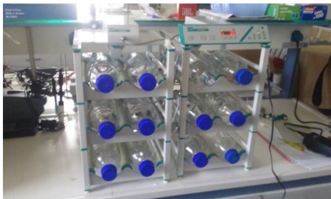
Εικόνα 5.5: Μηχανισμός ανάδευσης
