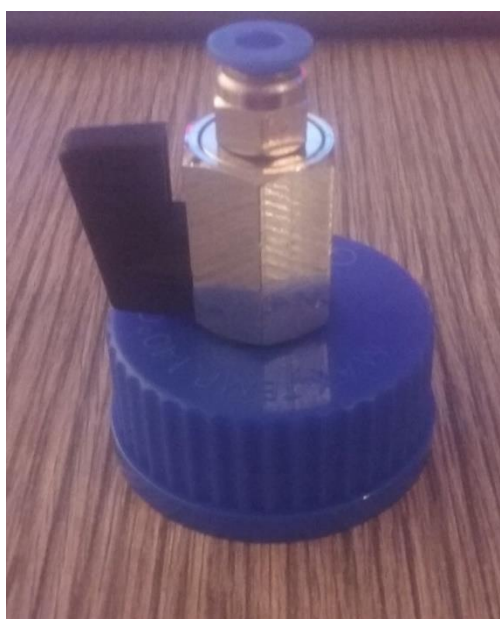
Εικόνα 5.2: Βάνα υψηλής πίεσης προσαρμοσμένη στο πώμα της φιάλης
