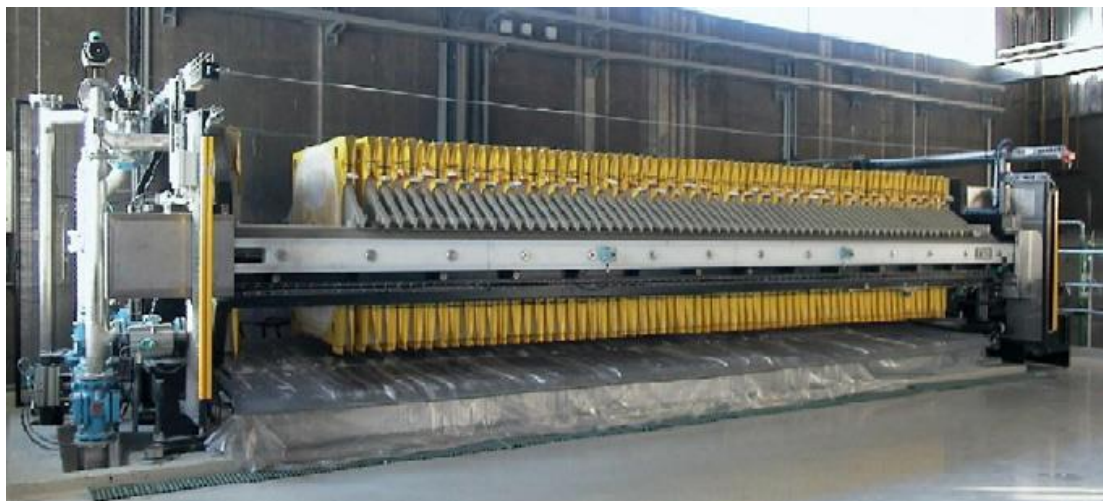
Εικόνα 2.3: πλευρική όψη φιλτρόπρεσσας (Wakeman, 2007)
