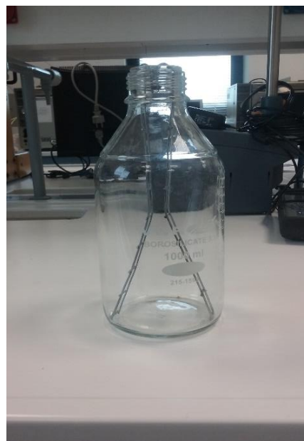
Εικόνα 5.7: Μεταλλικά πτερύγια τοποθετημένα εντός της φιάλης
