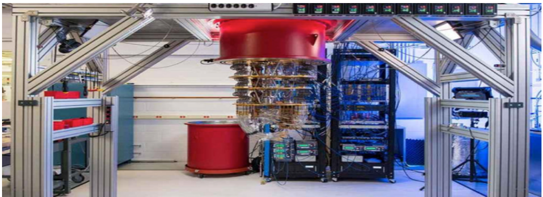
Εικόνα: Ο πρότυπος κβαντικός υπολογιστής της Google βασισμένος στην τεχνολογία των ψυχρών υπεραγώγιμων κυκλωμάτων
