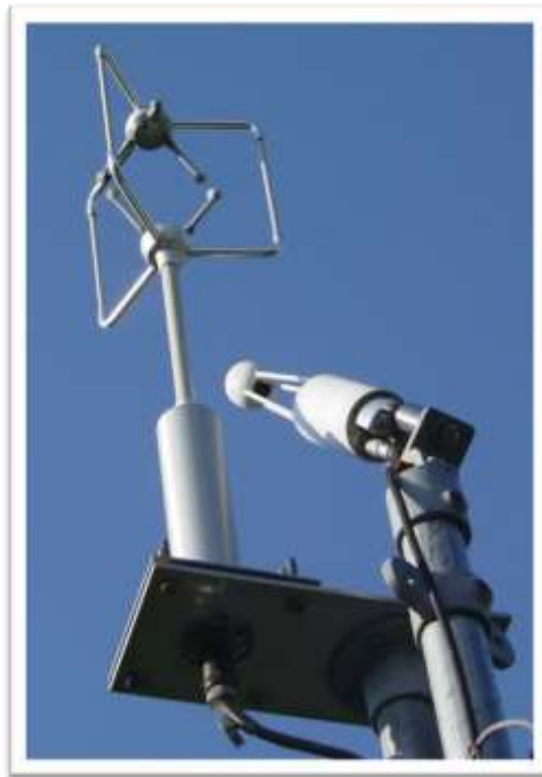
Εικόνα 3.6: Σύστημα με ανεμόμετρο υπερήχων και αναλυτή αερίων
