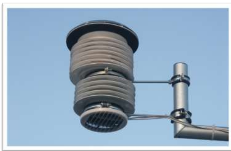
Εικόνα 3.1: Κλωβός προστασίας του αισθητήρα θερμοκρασίας αέρα
