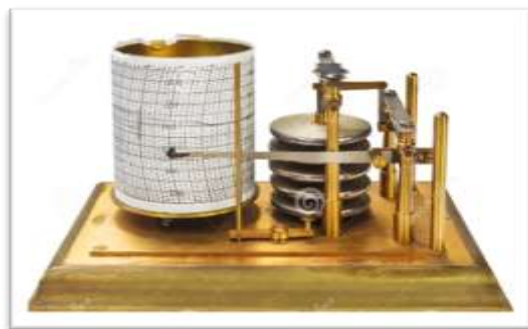
Εικόνα 3.8 : Μεταλλικός βαρογράφος
