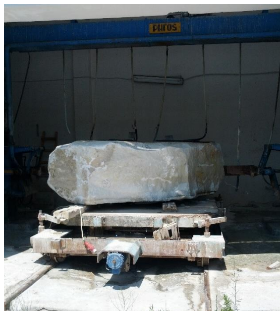
Εικόνα 34: Στιγμιότυπο ορθογωνισμού όγκου μαρμάρου
