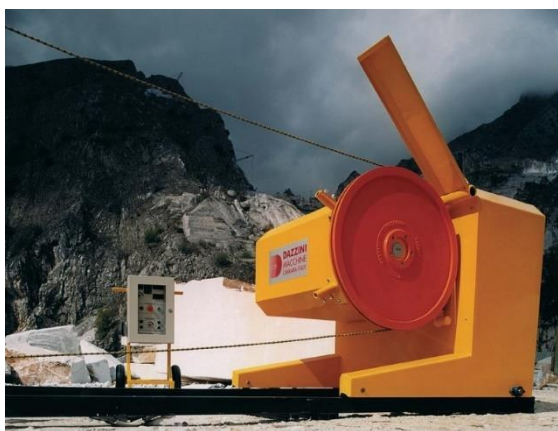
Εικόνα 29: Σύστημα συρματοκοπής [ http://www.dazzinimacchine.com/uk/diamond-wire-machines-for-marble/series-1000-widecutter-for-marble.asp ]
