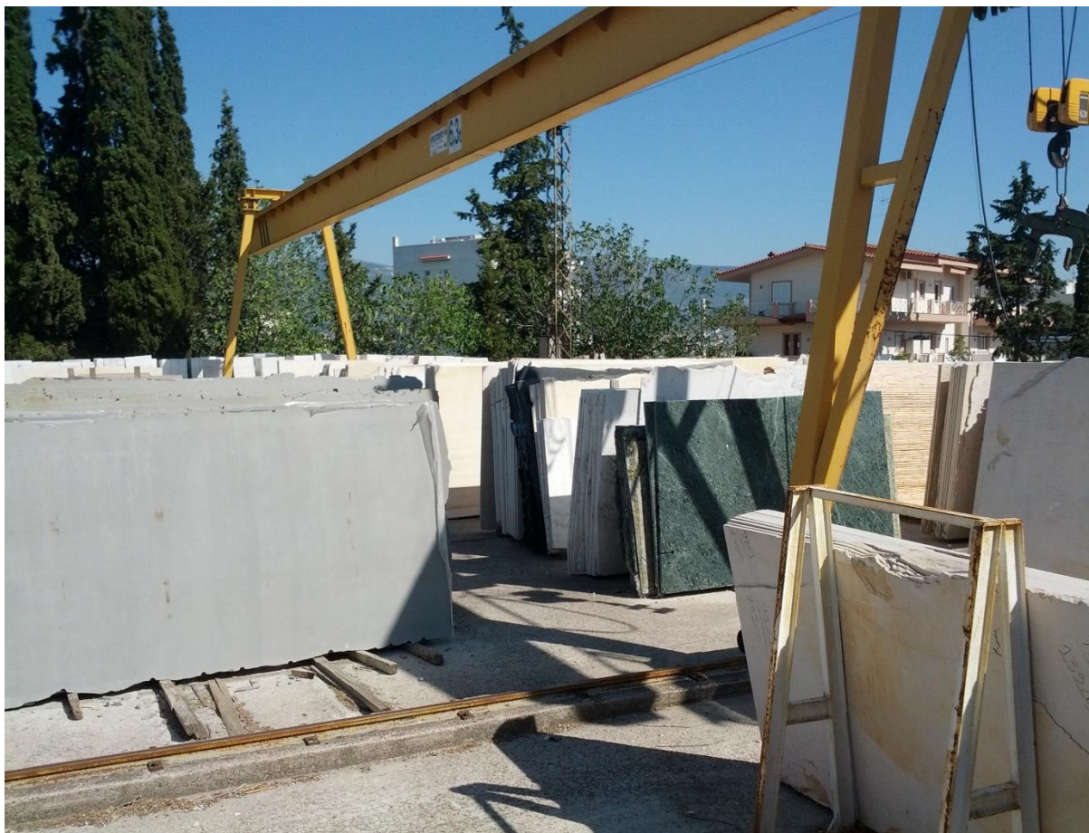
Εικόνα 38: Σχισμένες πλάκες μαρμάρου και γρανίτη στην πλατεία σχιστηρίου
