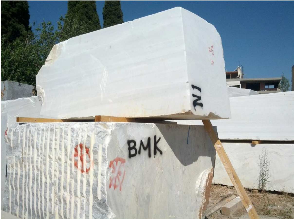
Εικόνα 24: Εξορυγμένος όγκος μαρμάρου έτοιμος για επεξεργασία
