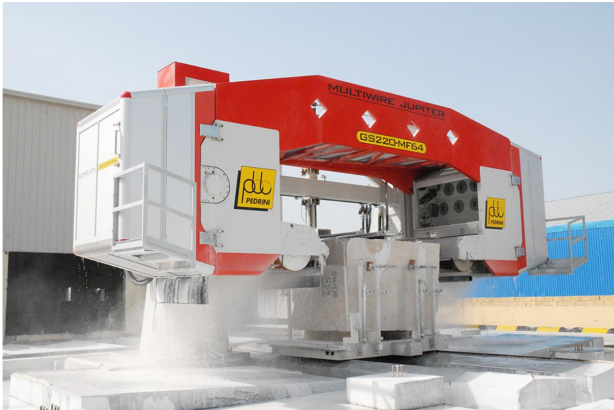
Εικόνα 40: Πολύσυρμος κατά τη διάρκεια κοπής όγκου γρανίτη [ https://www.pedrini-italia.it/en/products/multiwire-jupiter-gs220-0 ]
