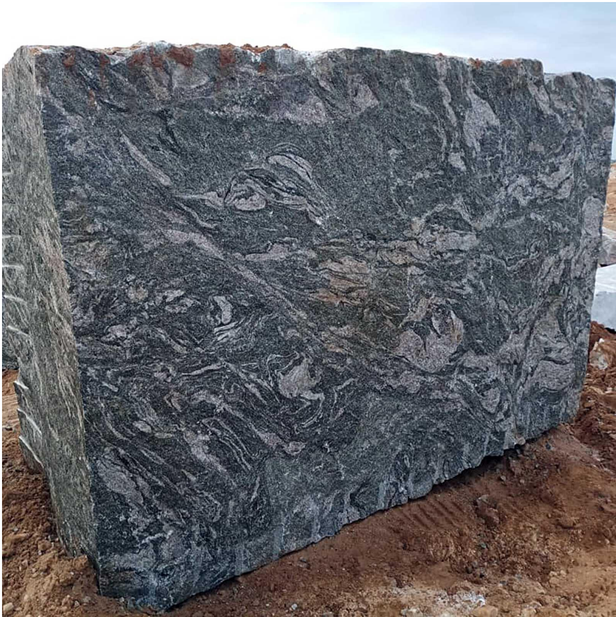
Εικόνα 12: Εξορυγμένος όγκος γρανίτη, έτοιμος για επεξεργασία και κοπή [ https://www.regattaexports.com/product/kuppam-green-granite-block/ ]
