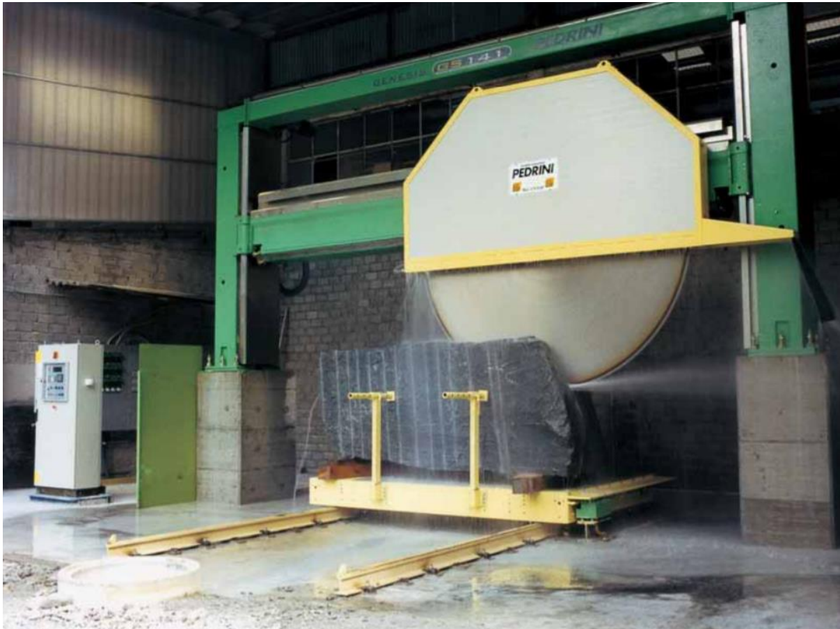
Εικόνα 37: Γιγαντιαίος δίσκος κοπής κατά τη διαδικασία διαχωρισμού όγκου [ https://www.pedrini-italia.it/en/products/genesis-gs141-142 ]
