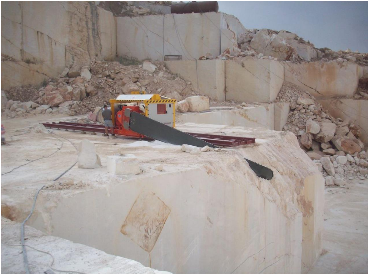
Εικόνα 32: Παράδειγμα χρήσης αλυσοπρίονου στο πεδίο [ https://www.fantinispa.it/en/70superh-bank-chain-saw-machine/ ]
