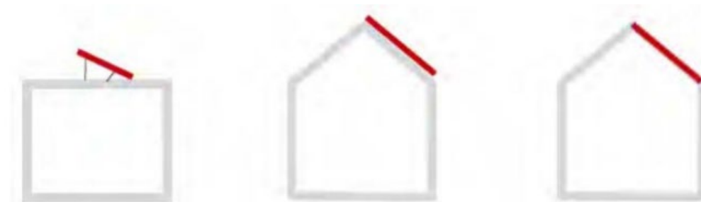
Εικόνα 8: Τρόποι ενσωμάτωσης φωτοβολταϊκών πλαισίων σε στέγη
