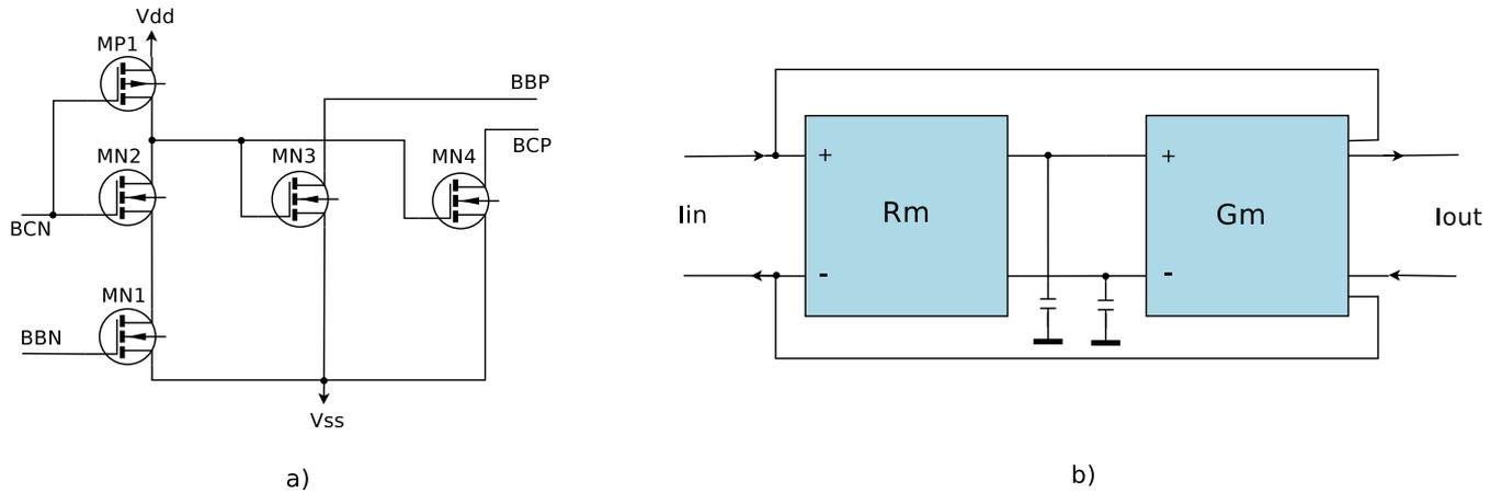
Figure 4.10: a) Start up circuit b) Gm current mode integrator.
