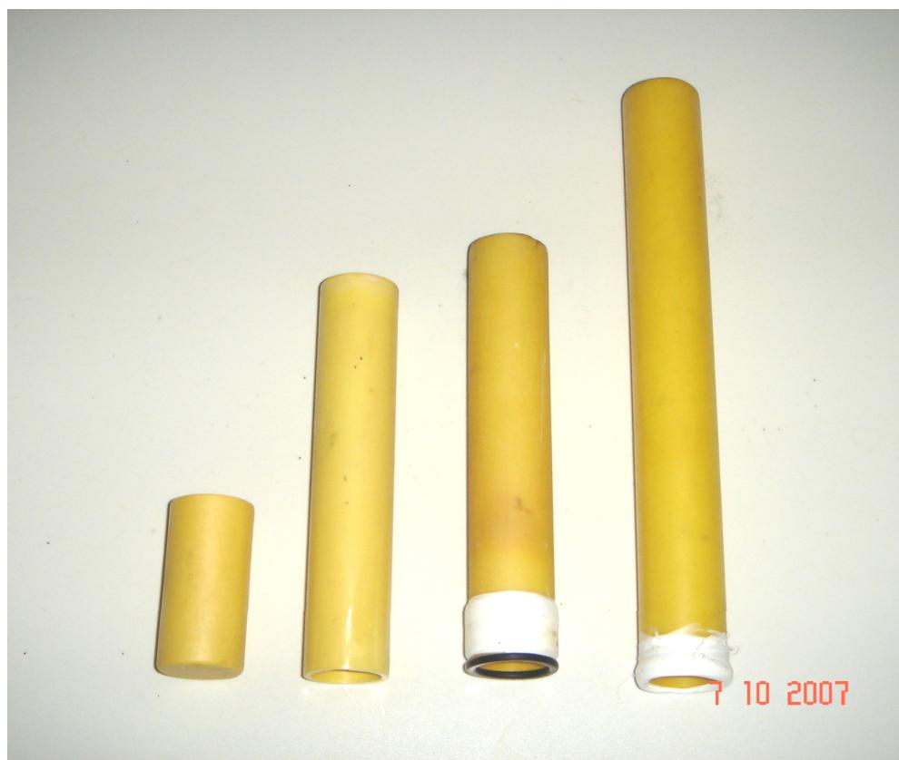
**Σχήμα ΙΙ.1:** Δείγματα στερεών ηλεκτρολυτών βασισμένων σε οξείδιο του ζιρκονίου σταθεροποιημένου με οξείδιο του νιτρίου (YSZ) σε μορφή σωλήνων κλειστού του ενός άκρου (διαφόρων διαστάσεων), οι οποίοι προμηθεύτηκαν από το εμπόριο.
