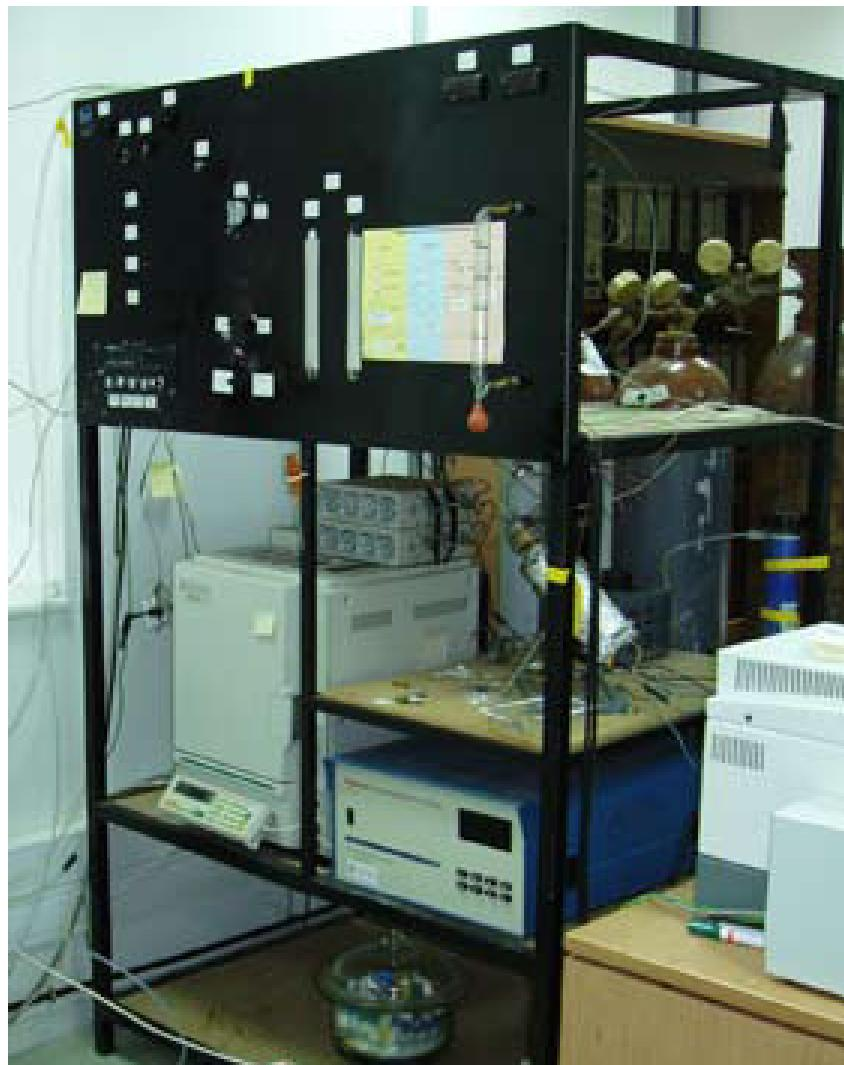
**Σχήμα II.13:** Απεικόνιση της πειραματικής διάταξης ελέγχου δραστικότητας καταλυτών και αποδοτικότητας κυψελίδων καυσίμων.
