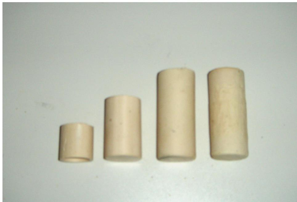
**Σχήμα II.2:** Δείγματα στερεών ηλεκτρολυτών βασισμένων σε GDC σε μορφή σωλήνων κλειστού του ενός άκρου (διαφόρων διαστάσεων), οι οποίοι παρασκευάστηκαν με την μέθοδο της χύτευσης.
