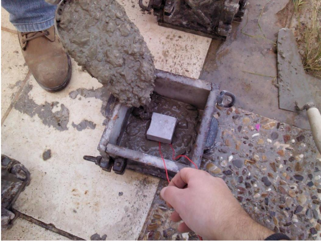
Εικόνα 8 Smart aggregate inside the cubic specimen
