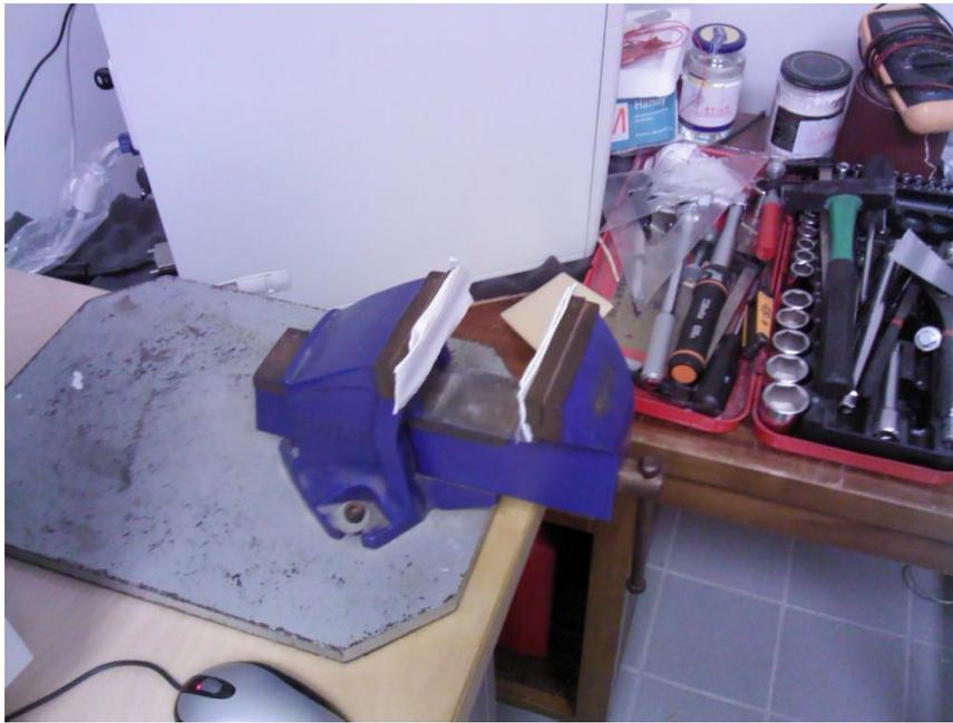
Εικόνα 10 Manual compression of “smart” aggregates
