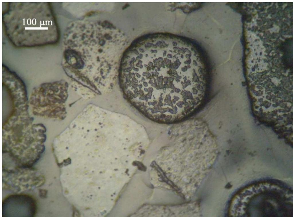
Εικόνα 6.15: Φωτογραφία βωξιτικών και ασβεστιτικών κόκκων του προϊόντος  $+2,70 \text{ gr/cm}^3$  του διαχωρισμού βαρέων υγρών του κλάσματος  $0,25-1\text{mm}$
