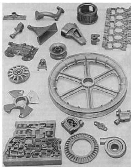
Σχήμα 2.1: Χυτά διαφορετικών υλικών, μεγέθους και γεωμετρίας [πηγή: Internet]
