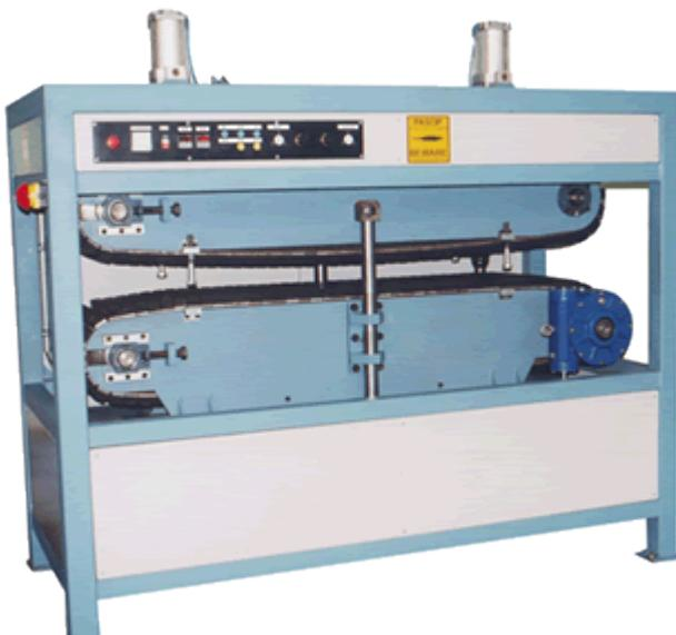
Το τράβηγμα του σωλήνα επιτυγχάνεται μέσω ενός συστήματος Haul-off. Διαθέτει δυο αντίρροπα κινούμενους ιμάντες, ανάμεσα στους οποίους βρίσκεται ο σωλήνας. Η ταχύτητα των κυλίνδρων καθορίζεται από το σύστημα ελέγχου.
