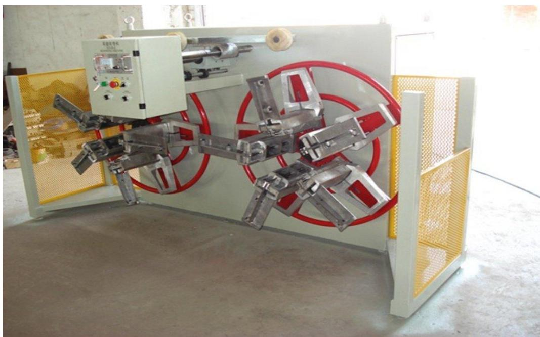
Η ανέμη είναι ένας μηχανισμός που χρησιμοποιείται για την περιτύλιξη του σωλήνα σε κουλούρες. Η λειτουργία της είναι συνεχής και αυτόματη. Συγκεκριμένα, μόλις ολοκληρωθεί η περιτύλιξη μίας κουλούρας, χωρίς να διακοπεί η λειτουργία της, μέσω ενός μαχαιριού, κόβεται ο σωλήνας και η άκρη του περνά σε δεύτερο σημείο τύλιξης. Η
