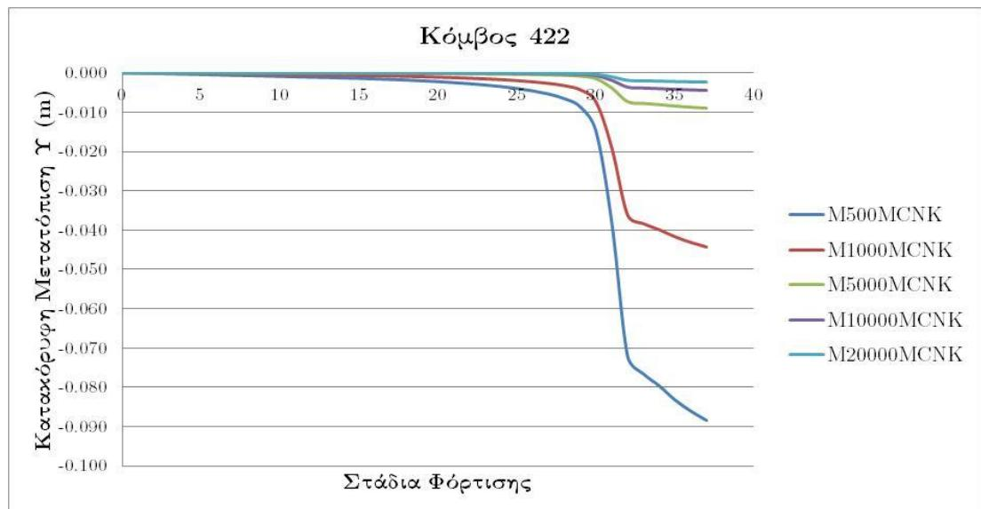
**Σχήμα 4.26:** Διάγραμμα κατακόρυφων μετατοπίσεων συναρτήσει των σταδίων φόρτισης σε κόμβο ελέγχου για διατομή χωρίς υποστήριξη κολιών
