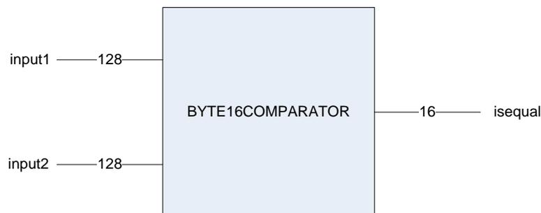
Figure 4.6. 16-Byte Comparator Interface
