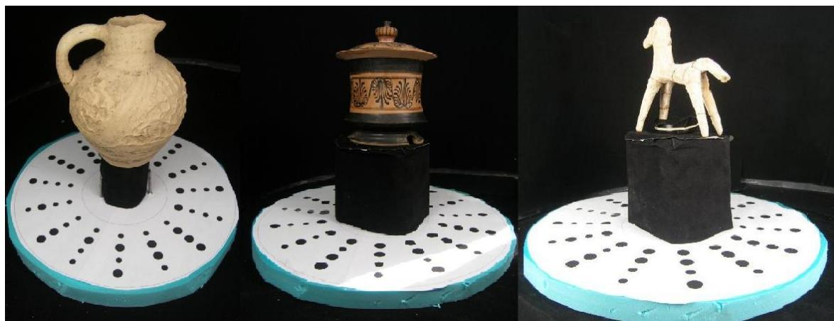
Εικόνα 20: Τοποθέτηση μοντέλων στον τρισδιάστατο σαρωτή βάθους (3D scanner).
