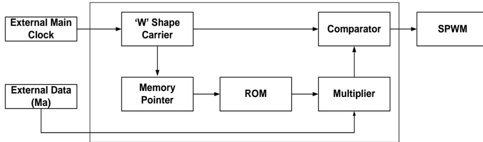
Fig. 21. Block diagram of SPWM.
