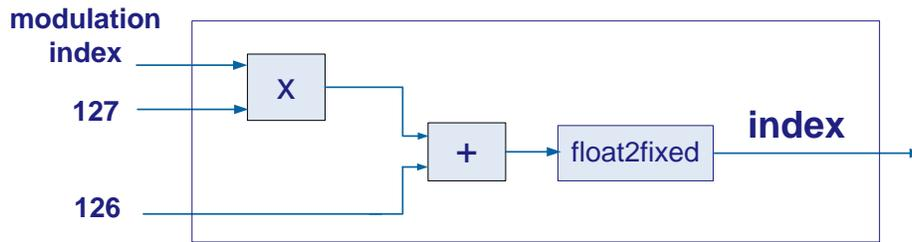
Fig. 28. Modulation index subsystem.
