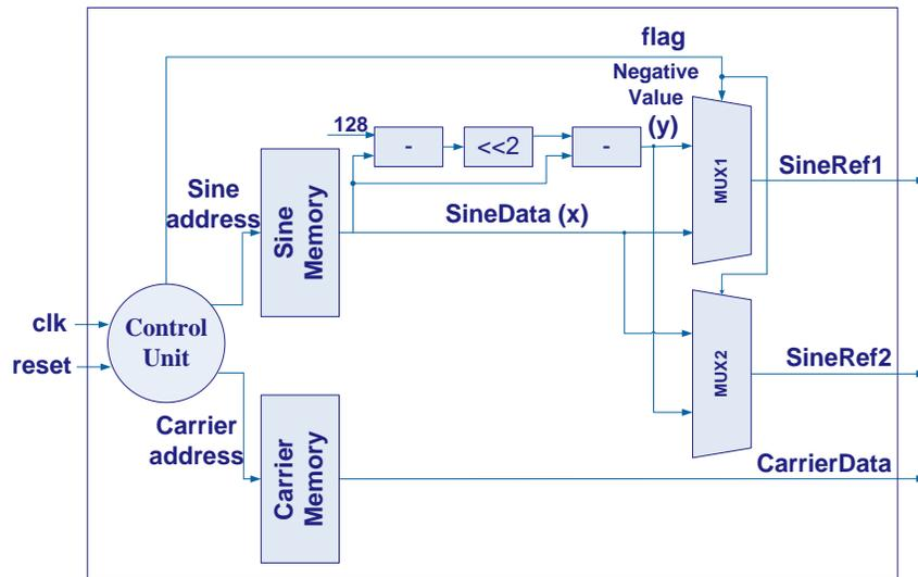
Fig. 29. Sine-Carrier subsystem.
