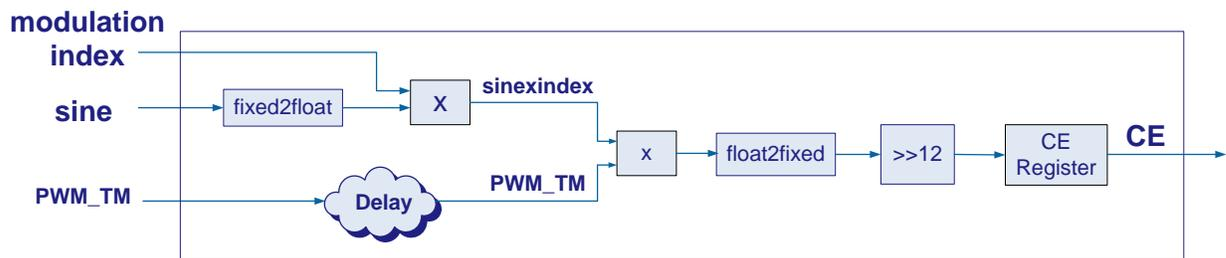
Fig. 43. CE calculation module.
