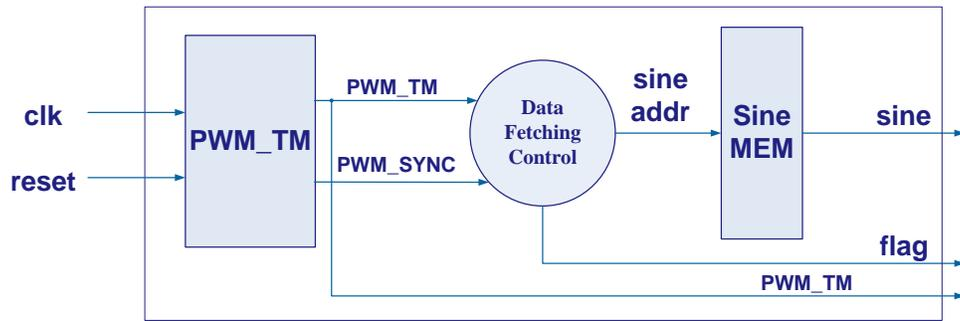
Fig. 42. Sine data module.
