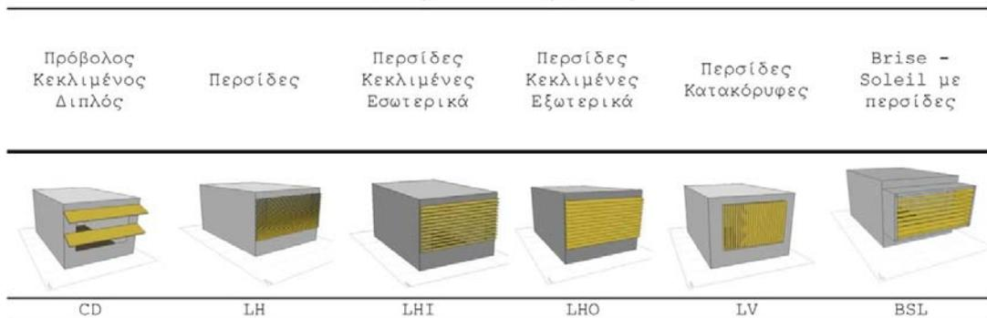
**Εικ.0.2.4.** Εξεταζόμενοι τύποι συστημάτων σκίασμού με ενσωματωμένα φωτοβολταϊκά στοιχεία που δεν εξασφαλίζουν επαφή με το εξωτερικό περιβάλλον
