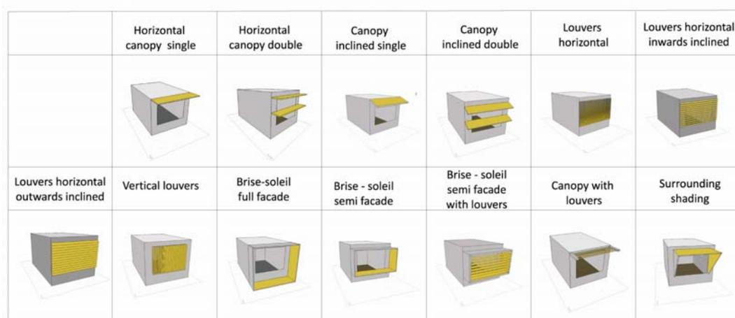
**Εικ.0.2.2.** Εξεταζόμενοι τύποι συστημάτων σκίασμού με ενσωματωμένα φωτοβολταϊκά στοιχεία.
