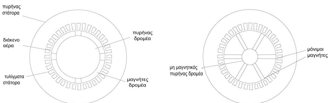
Εικόνα 2.1 Κινητήρας επιφανειακό (αριστερά) και εσωτερικό (δεξιά) μόνιμου μαγνήτη
