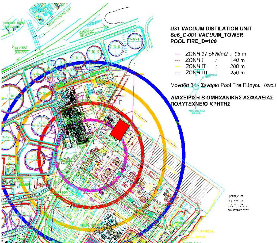
**Σχήμα 5.4.1.2:** Ζώνες επιπτώσεων (σε m) από φωτιά λίμνης (POOL FIRE) στη μονάδα U31: Vacuum Distillation Unit
