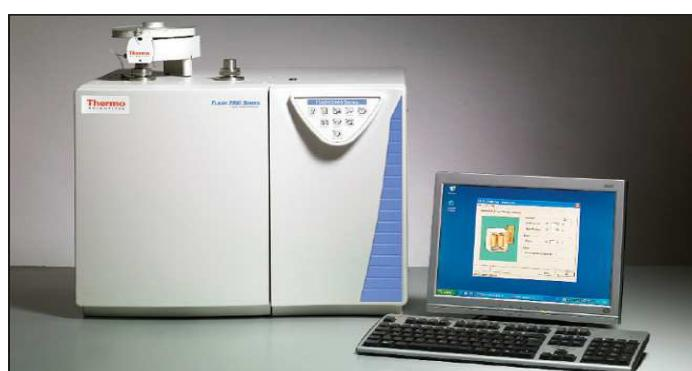
**Σχήμα 3.1:** Αυτόματος στοιχειακός αναλυτής Flash 2000 Series, της εταιρίας Thermo Fisher Scientific ([www.petro-online.com/news/measurement-and-testing/14/thermo\\_fisher\\_scientific\\_uk](http://www.petro-online.com/news/measurement-and-testing/14/thermo_fisher_scientific_uk))
