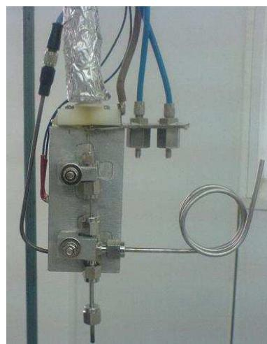
**Σχήμα 3.16:** Σύνδεσμος (interface) μεταφοράς των αερίων από το θερμοζυγό στον φασματογράφο μάζας.
