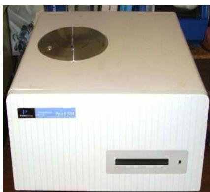
Σχήμα 3.13: Θερμοζυγός Pyris 6 TGA, της εταιρίας Perkin Elmer ([www.researchndevelopment.com](http://www.researchndevelopment.com))
